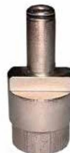
Ponta montada para afiação e recuperação dos botões das Coroa. Para escolher a ponta montada ideal, deve-se observar o diâmetro do botão e sua forma (balística ou esférica).
